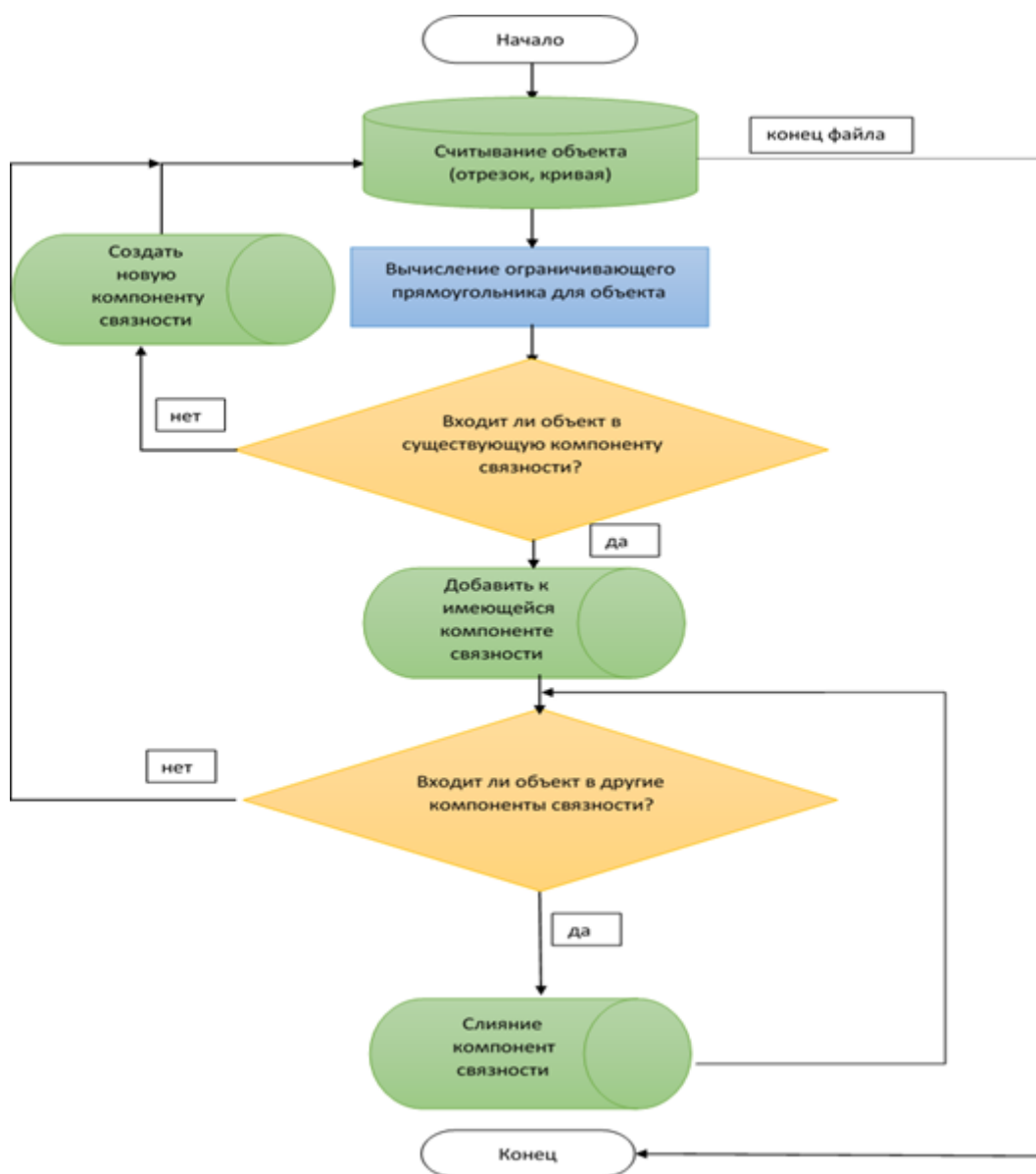
Рисунок 2.9 - Блок-схема выделения проекционных видов.
