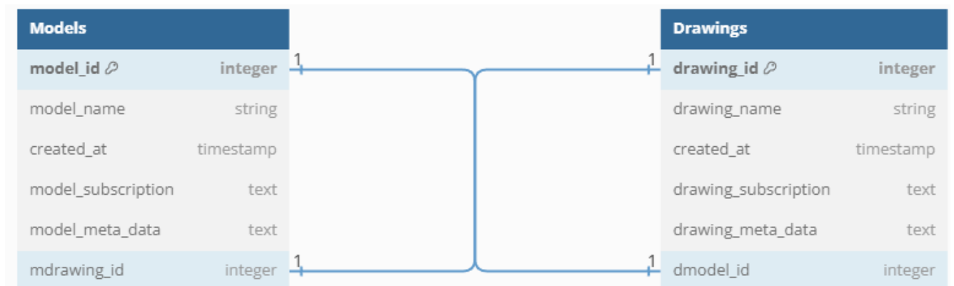
Рисунок 5.3 - Связь между двумерными и трехмерными данными.
