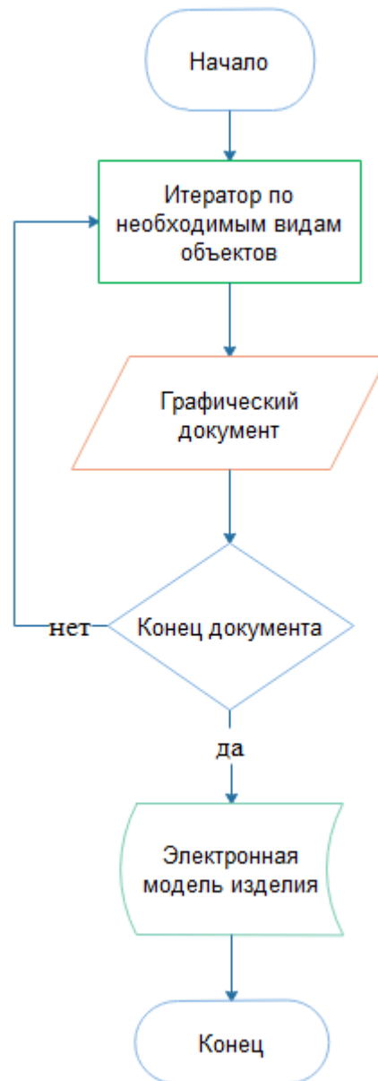
Рисунок 2.4 - Принцип работы прикладной программы при чтении геометро-графической информации.
